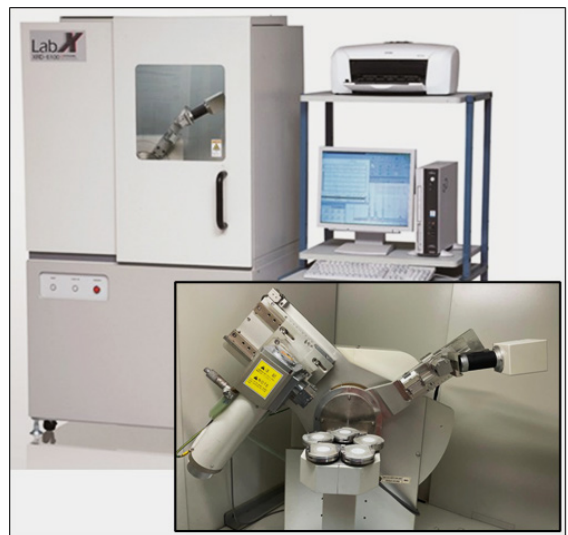
X-RD MAXima dengan komponen source dan detector
