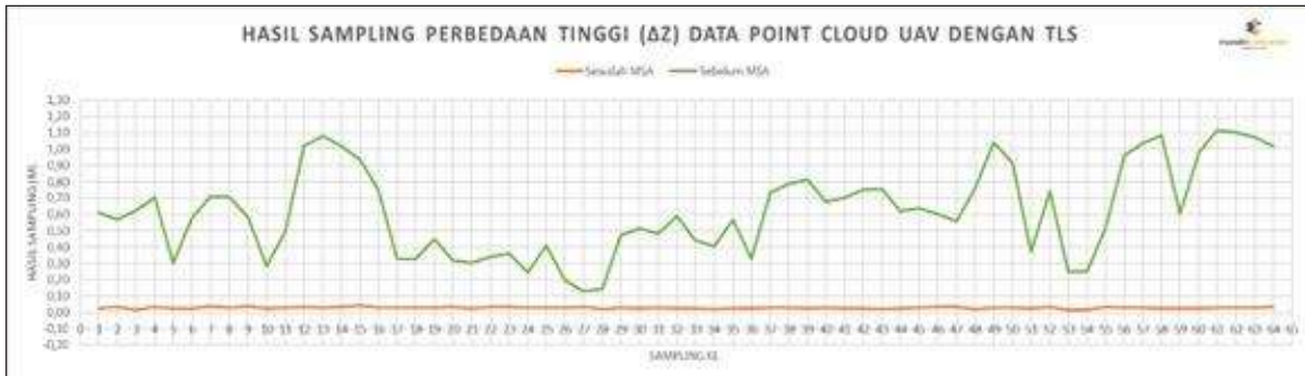
Gambar 6 Grafik Hasil Sampling Perbedaan Tinggi Data Point Cloud UAV dengan TLS
