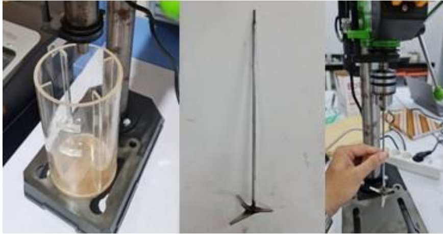
Gambar 3. Perancangan wadah, Propeller dan Mesin Agitator
