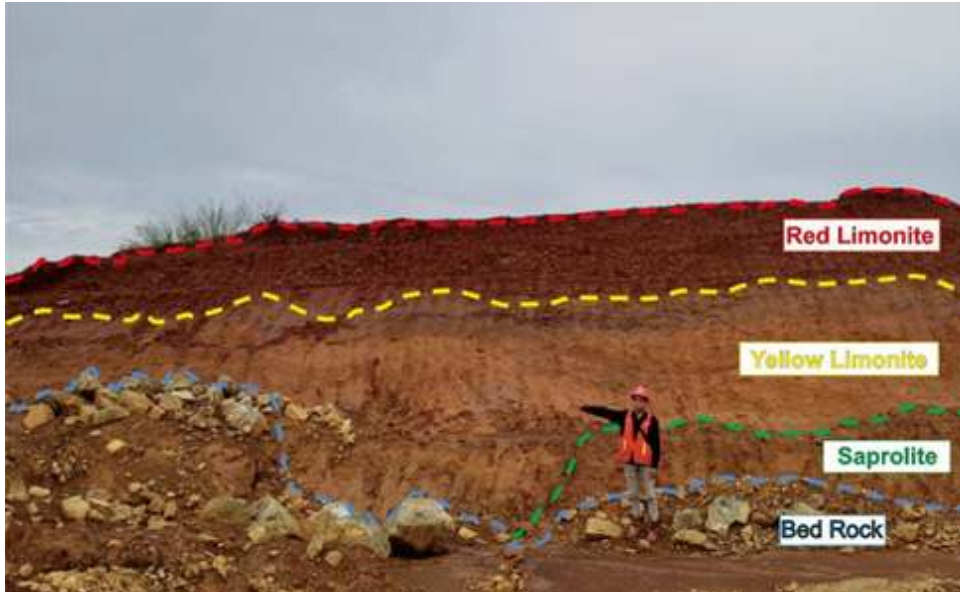
Salah satu contoh profile laterit tipe oxide yang berada di Kalimantan Selatan
