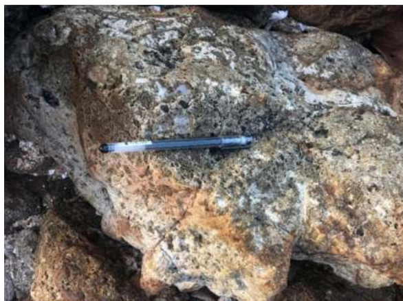
Tekstur Vuggy Silica di Pulau Merah, salah satu penciri deposit emas High Sulphidation (kiri). Tebing sisi Selatan Pulau Merah, terdapat singkapan alterasi dan mineralisasi tembaga porfiri, malakhit warna hijau, oksida besi warna merah bata (kanan).
