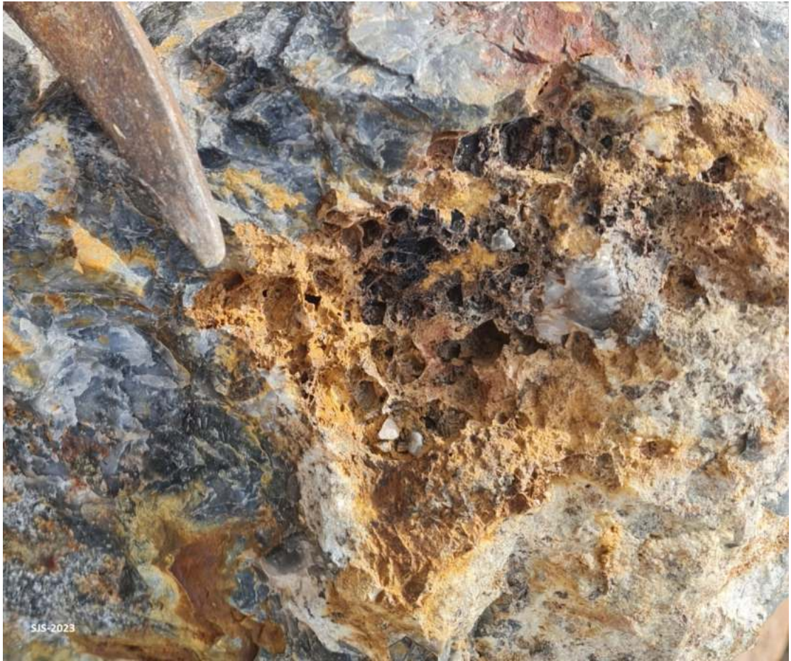
Boxwork pada urat kuarsa Sn-W polimetalik, di Tambang Tikus, Belitung
