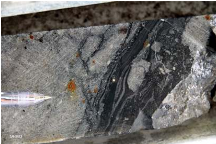
Bijih emas sediment hosted , dengan host rock serpih karbonatan.
