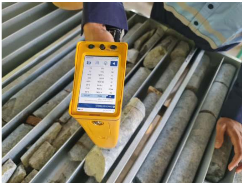
XRF untuk pengujian sampel inti bor
