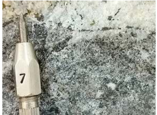
Tonalit sebagai host rock tembaga porfiri terpotong urat kuarsa, memiliki tekstur kristal lebih halus dibandingkan granit timah, lokasi di Grasberg, Papua.
