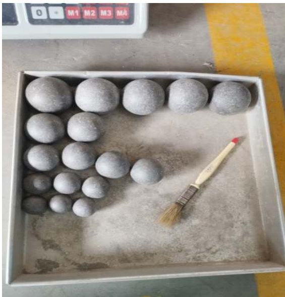
Ragam ukuran bola untuk ball mill
