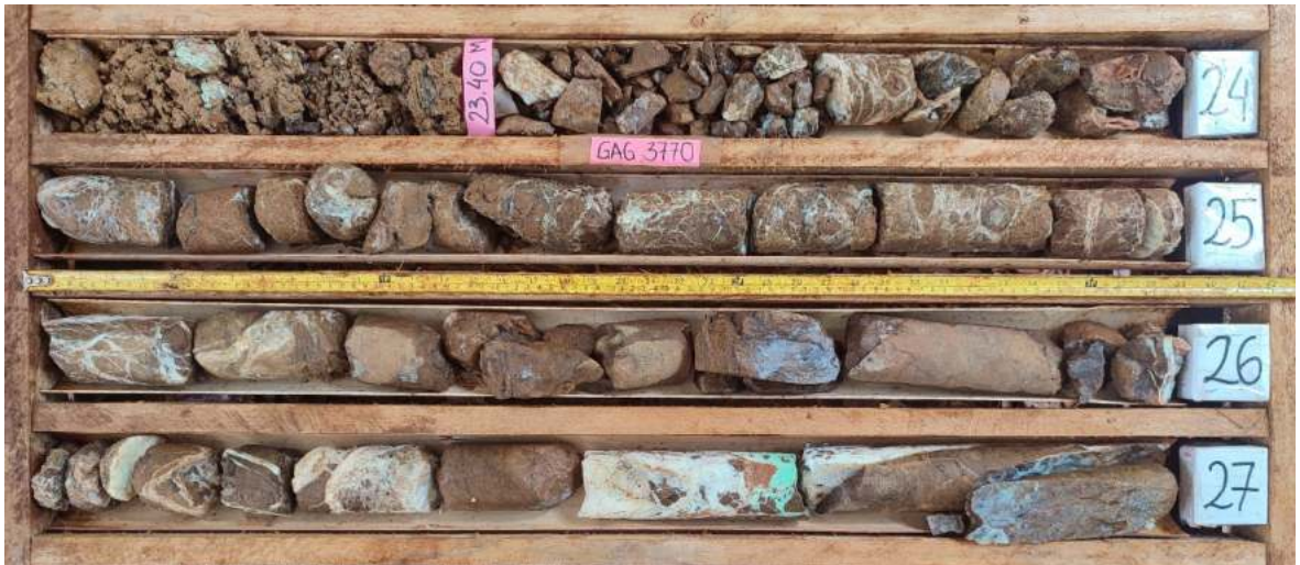
Silika boxwork terdapat pada batuan dasar, membentuk urat silika dan veinlet silika
