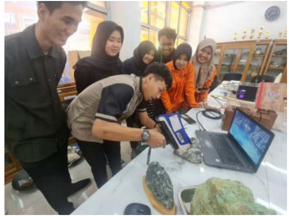
Mempraktikkan penggunaan XRF untuk mengetahui unsur yang ada pada sampel bijih di Lab PEP-B
