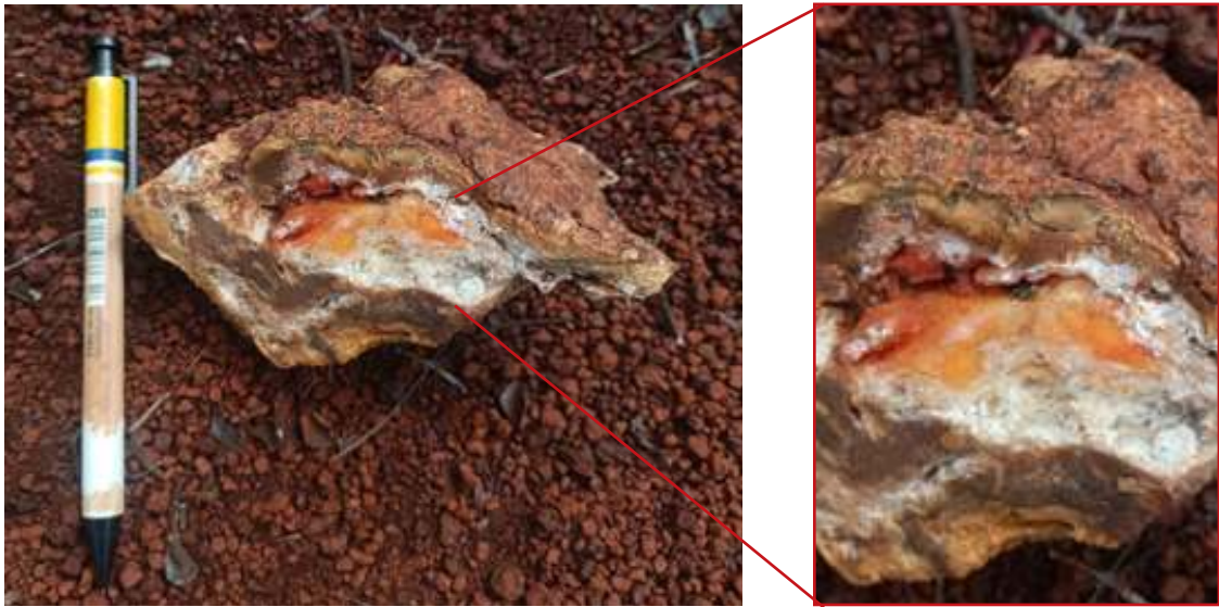
Mineral Quartz terdapat di dalam Silika Boxwork
