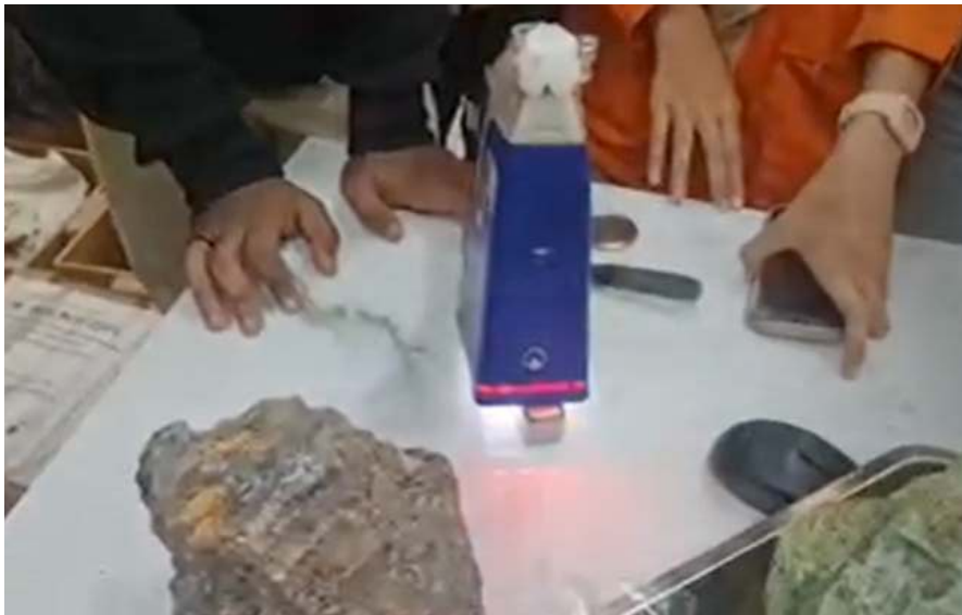
Mempraktikkan penggunaan XRF untuk mengetahui unsur yang ada pada sampel bijih di Lab PEP-B
