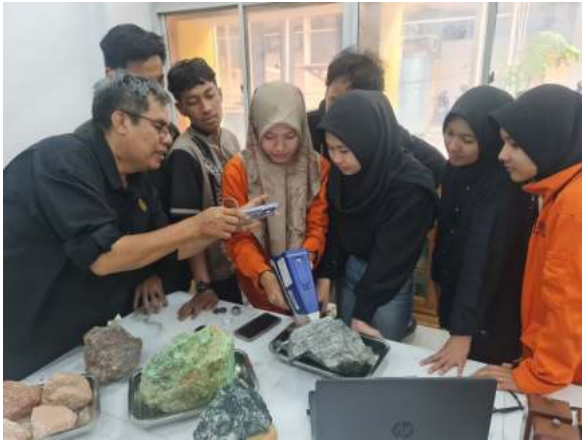
Mempraktikkan penggunaan XRF untuk mengetahui unsur yang ada pada sampel bijih di Lab PEP-B
