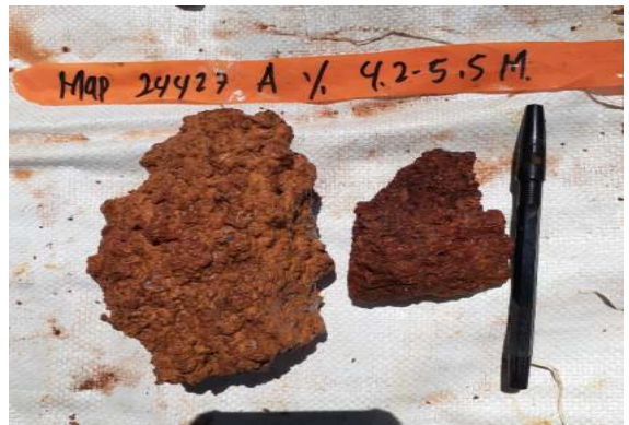
Bauksit sebelum pencucian, masih terdapat banyak lempung (kiri) dan bauksit setelah pencucian hanya tersisa konkresi saja (kanan)
