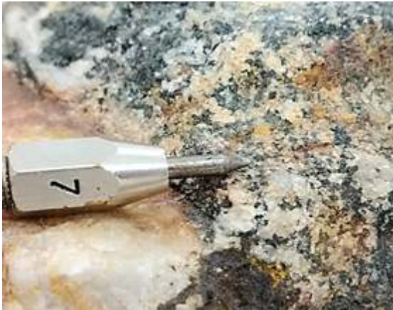
Granit biotit terpotong urat Sn-W polimetallik, tekstur kristal kasar, lokasi di Kepoh, Toboali, Bangka.
